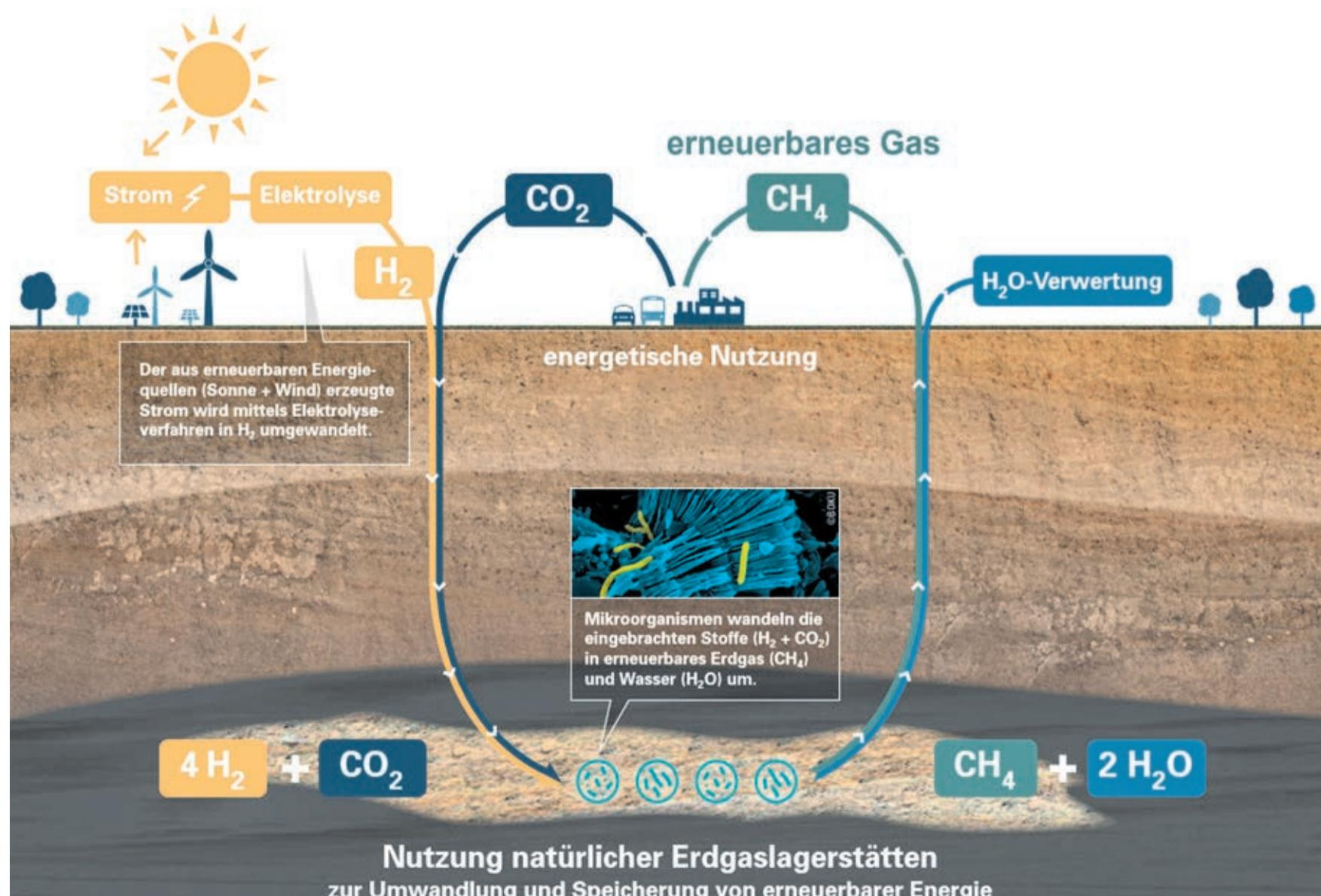
Schematische Darstellung einer Anlage, bei der erneuerbarer Wasserstoff ( $\text{H}_2$ ) und Kohlendioxid ( $\text{CO}_2$ ) in den durchlässigen Gesteinsschichten einer früheren Erdgaslagerstätte eingelagert und dort von Mikroorganismen in erneuerbares Gas umgewandelt werden.
