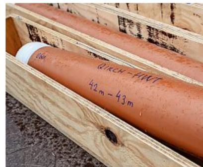
Die Bohrkerns werden in Rohre und Kisten verpackt und im Labor untersucht.
