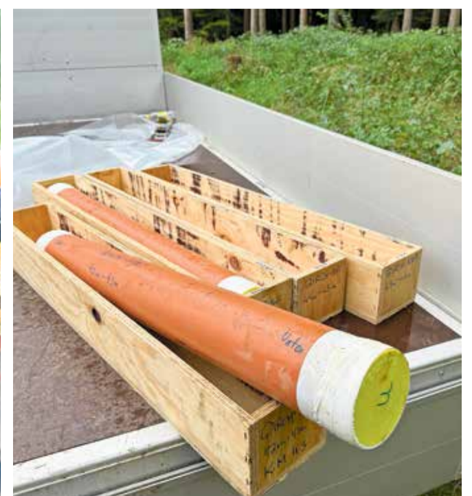
V.l.: Die Baggerschlitzsondierungen sind ausgeführt, die Bohrungen laufen seit Ende August (Karte zvgl.). Spezielle Kernfangfedern verhindern, dass das lose Bohrgut herausfällt. Es wird in Plastikröhren gelagert.
