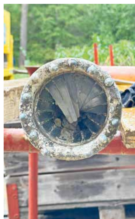
V.l.: Die Baggerschlitzsondierungen sind ausgeführt, die Bohrungen laufen seit Ende August (Karte zvgl.). Spezielle Kernfangfedern verhindern, dass das lose Bohrgut herausfällt. Es wird in Plastikröhren gelagert.
