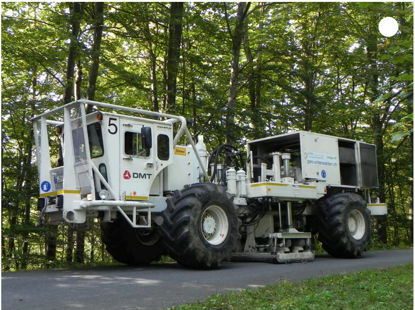
Ein Vibrationsfahrzeug zur Untersuchung des Thurgauer Bodens. Die Vibrationen gehen bis in 4000 Metern Tiefe
