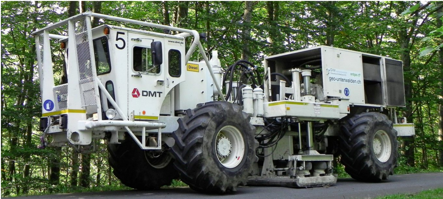
Ein Vibrationsfahrzeug zur Untersuchung des Thurgauer Bodens. Die Vibrationen gehen bis in 4000 Metern Tiefe.
